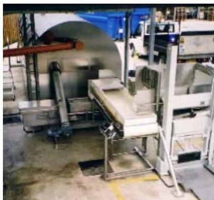
È inoltre possibile l'installazione di un tritatore, in modo da poter alimentare, oltre che gli scarti alimentari, anche il materiale proveniente da sfalci e potatura. Inoltre si prevede l'installazione di un sistema di drenaggio dell'acqua per ridurre l'eventuale eccessiva presenza di acqua nel flusso in ingresso e un sistema di iniezione dell'acqua per far fronte ai casi in cui il materiale in ingresso sia secco.
