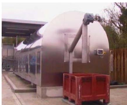
Infine, per il trattamento dell'aria di scarico del processo di compostaggio si prevede l'installazione di un biofiltro, al fine di evitare dispersione di cattivi odori. Il compost prodotto è pari al 10% del materiale alimentato.
